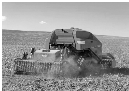
Рис. 1б. Автономный полевой робот Karl от Kuhn Group.
