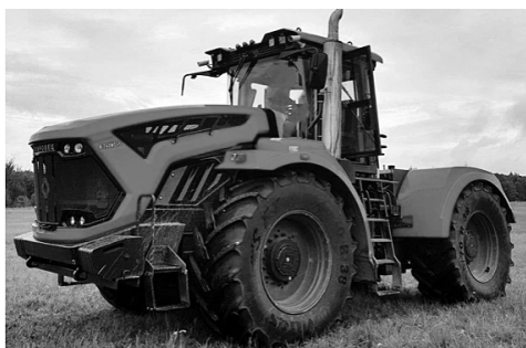
Рис. 2а. Трактор «Кировец» петербургского производства с беспилотной системой Cognitive Pilot (2023)
